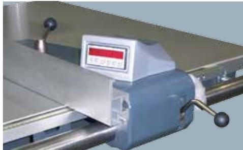
**VISUALIZZAZIONE DIGITALE DELLE MISURE SULLA GUIDA PARALLELA**
