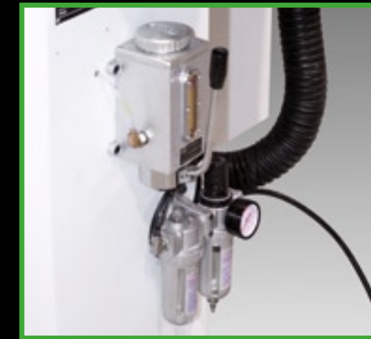
Pompa lubrificazione piano
