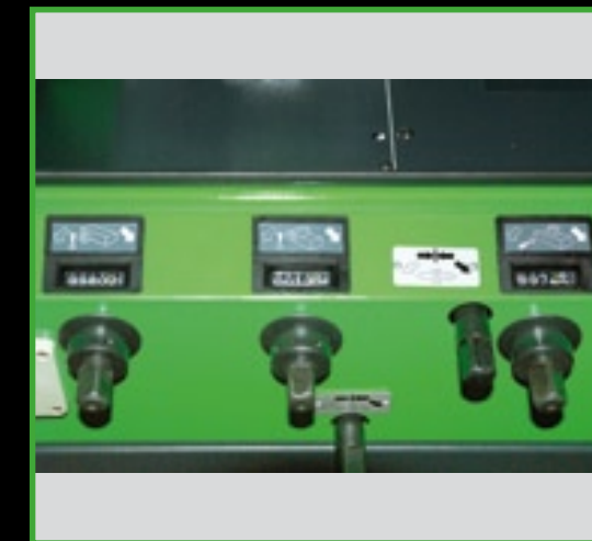
Indicatori digitali per lo spostamento assiale e radiale degli alberi
