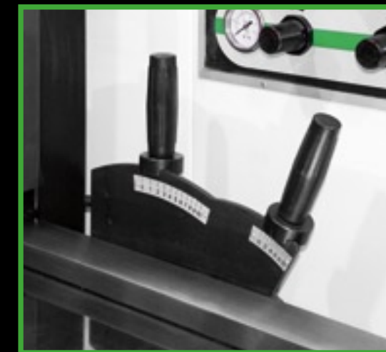
Doppia leva per lo spostamento piano in entrata e di destra
