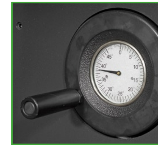
Inclinazione lama con indicatore decimale Decimal display of tilting blade Inclinacion de la sierra con indicator decimal Inclinaison lame avec visualisation decimal
